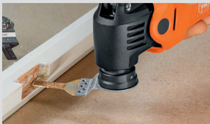
Čisté a přesné vypilování výřezů.
