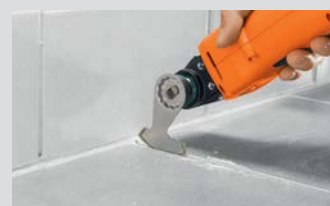
Diamantový segmentový nůž pro řezy až do rohu.
