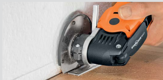
Dilatační spáry lze výborně doříznout.
