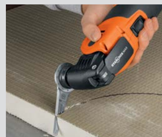
Přířezávání stavebních desek.
